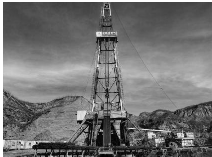
近日,陕西省一九四煤田地质有限公司所属中深部钻井公司ZJ40井队施工的山西柳林煤层气多分支井钻井项目SX-036-DFZ01井R1、L2两分支筛管下入预定煤层位置,达到设计目的。R1、L2分支长度均为600米。杨卫超 摄影报道
