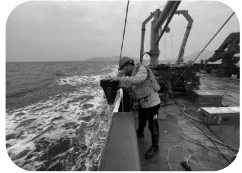
近日，山东省煤田地质局一队承担了青岛市西海岸新区东部海域水深地形测绘与气象数据采集项目。此次调查旨在查明工作区内的水深、地形，以及风速、风向、气压、气温、湿度等气象参数，为青岛深远海绿色养殖区高质量建设提供技术服务和基础资料。
