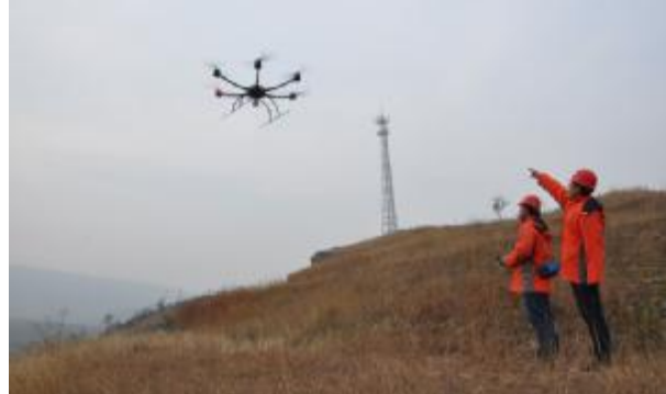
实施无人机地形测量作业
