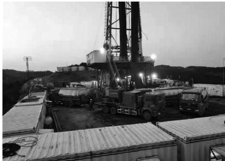
随着山西马煤层气项目固井的最后一道工序——注胶替液碰压15兆帕的成功，青海煤炭地质局一〇五队圆满完成94井组施工任务。该项目是ZJ40钻机从日费模式转向大包模式的第一个项目。施工中，全体工作人员积极配合甲方“高水平段全井固井施工试验”，并总结出最适合该区块施工的高比重、高切力泥浆体系，让94L-04井施工最终突破水平段套管扶正器摩阻大导致的下套管难关，为推广这一技术取得了实质性数据。李增科 陈军 摄影报道
