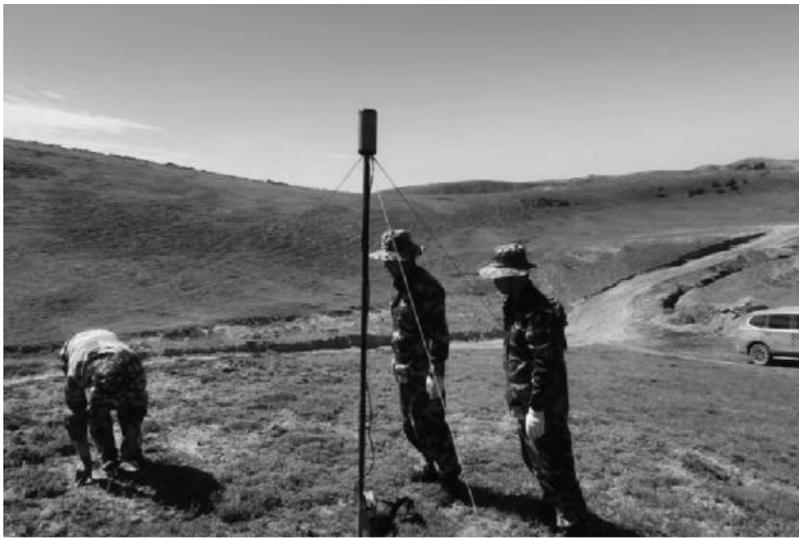
近日，由山东省煤地地质局物测队承担的“新疆阜康市大黄山煤矿地质灾害勘查”项目顺利竣工。据悉，该项目工作区位于博格达山北麓，准噶尔盆地南缘，属南准噶尔煤田东部。区内地形复杂，地势陡峻，沟谷及陡崖纵横，主要为构造剥蚀丘陵地形和洪积地，海拔标高974~1158米，相对高差184米。山东局物测队选派专业技术人员组成项目部，依据国家标准规范和要求，用瞬变电磁法勘查工作完成测点324个，圈定采空区两处；用磁法勘查工作完成测点927个，圈定火区一处。
