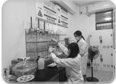
图为勘测公司检测中心实验室员工强月姣、张远航有条不紊地用EDTA配位滴定方法进行易溶盐中钙和镁离子的测定。
