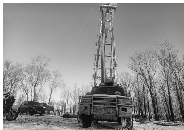
近日，总局一局集团一二九公司在沈阳康强测井勘探施工中，首次完成井下电视技术应用。井下电视成像不仅可以直观地监测井下油管或套管的技术状况，还可以监测到钻孔内地质层和裂隙状况，其解释结果更准确可靠。一二九公司物探技术服务部专业技术人员冒着大雪，在-30℃的严寒天气下进行野外施工，高质量完成了施工任务。
