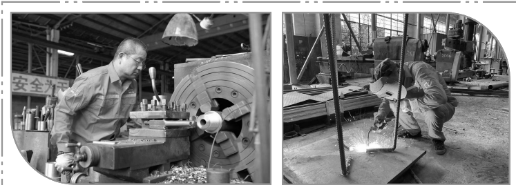
安徽省地面沉降监测网建设项目(阜阳部分)施工以来，安徽省煤田地质局一队生产保障中心积极行动，机修厂、器材科全体员工主动放弃节假日和周末休息时间，制作修复各类岩芯管100根、钻铤90根、各类加重管20根、变径接头200支、螺丝头160支，维修各类设备7台次等，为项目机件加工、材料筹备、设备维保和调用提供了保障。
